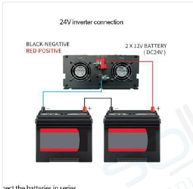
חיבור ממיר 24V — שני מצברי 12V בטור (וכך גם ב-48V: ארבעה בטור)
